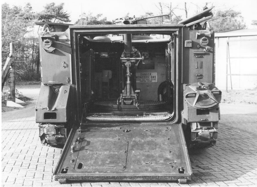
Afb. 07: Interieur van de mortierdrager met mortier 4.2-inch in de M106A1 PRRM. [Bron: Geschiedkundige Verzameling Regiment Technische Troepen]
