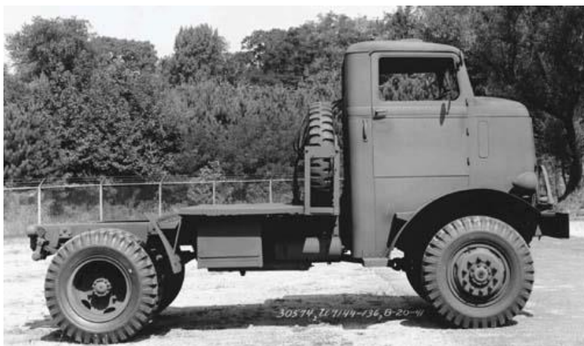
Afb. 04: Staatsiefoto van de Trekker: 5-ton, 4x4, U 7144T [Autocar]. (Foto: Internet)
