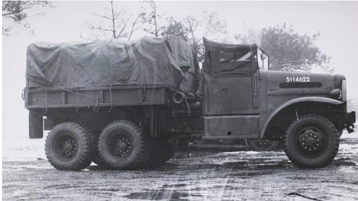
Afb 05: Artillerietrekker: 6 ton, 6x6, 4 dl, m/liet en open cabine. [Bron: Nederlands Instituut voor Militaire Historie].
