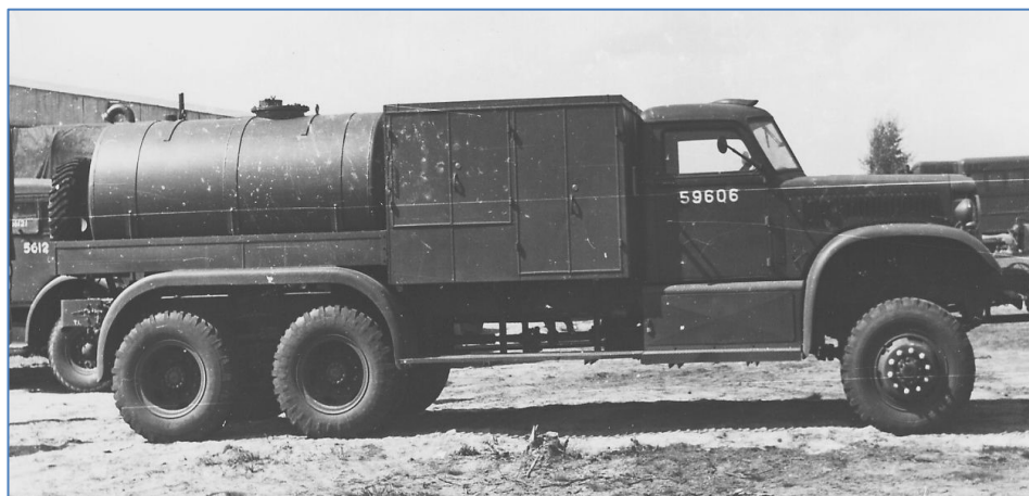
Afb. 4: VRACHTAUTO: 4 ton, 6x6, 4 dl, LWB, m/schuimblusinstallatie Geesink. (Bron: Historische Collectie Regiment Technische Troepen).
