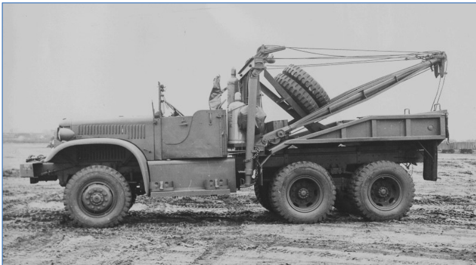
Afb. 3: Takelauto, 4 ton, 6x6, 4 dl, KWB, met lier, Diamond T, open cabine, met het korte 151 inch chassis.
