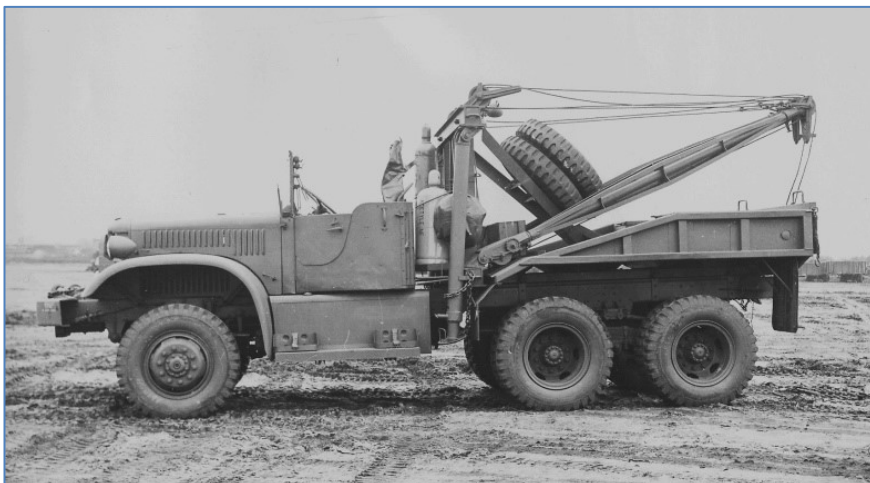
Afb. 6: Takelauto, 4 ton, 6x6, 4 dl, KWB, met lier, Diamond T, open cabine, met het korte 151 inch chassis.
