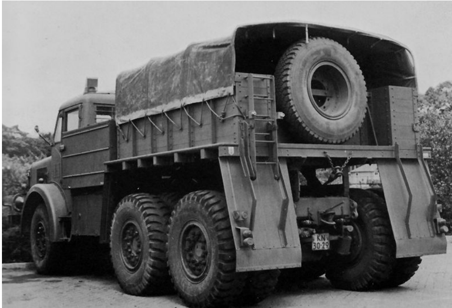
Afb. 3: Achterzijde van de Vrachtauto, Open Laadbak: 20 ton, 6 x 4, 4 DL, Mighty Antar (Thornycroft), nsn 2320-17-612-8912.
