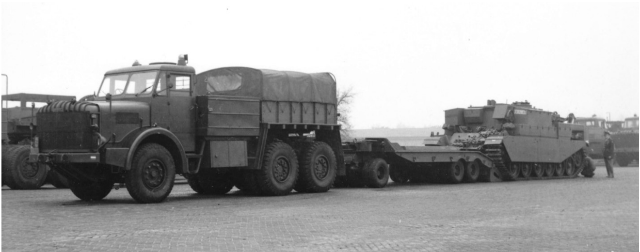
Afb. 1: Vrachtauto, open laadbak: 20 ton, 6 x 4, 4 DL, Mighty Antar (Thornycroft) gekoppeld aan de nog ongemodificeerde aanhanger, gevechtstankvervoer, 45 ton, 12 wielen gereed om te worden beladen met een Centurion ARV MK 2.
