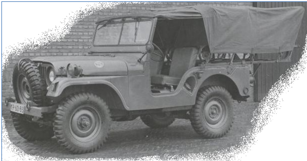
Afb. 8: Prototype van de gewondentransporteur met de reserveband op de voorbumper op basis van de Nekaf, M38A1 jeep.
