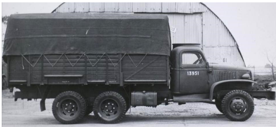
Afb. 6: Vrachtauto, Werkplaats : 2 1/2 ton, 6x6, CCKW-353 (GMC) met Engelse laadbakopbouw.
