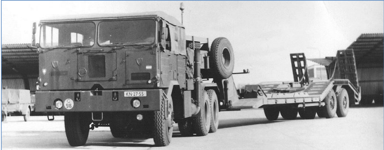
Afb. 4. Faun trekker KN-27-55 met aangekoppelde oplegger : 50 ton, 8 wielen, YTS-10.060 [DAF]. (Bron: Historische Collectie Regiment Technische Troepen).
