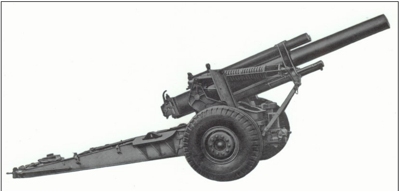
Afb. 02: 155mm Houwitsers M1 on 155mm Houwitsers Carriage M1 zonder gepantserd schild. Bron: Onbekend.
