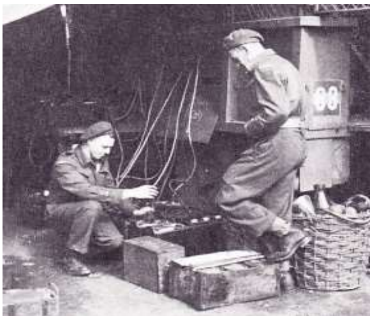
Afb 29 opladen 6 en 12 volt accu's te velde
