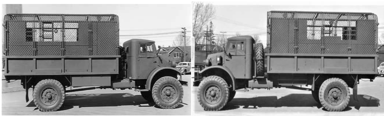
Afb 25 Het aanzicht van de rechter en linkerzijde van de Lorry, 3-ton, 4-wh, Stores. (3-ton, 4x4, 158" W.B.)
